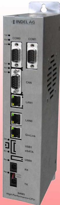
Die GinLink StandAloneMaster Karte ist der Feldbusmaster über einen Gin-Link. Die Karte läuft völlig autonom, und braucht im Betrieb keinen übergeordneten Rechner. Für die Visualisierung und Software Updates stehen ein 1Gbit Ethernet Port und zwei RS232 Schnittstellen und zur Verfügung. Das echtzeitfähige Multitasking-Betriebssystem des Masters übernimmt die gesamte Steuerung der Maschine/
