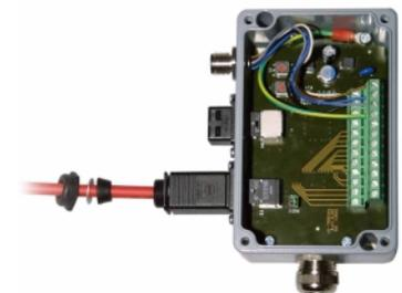
6. Kabelverschraubung anziehen. Der Push Pull-Steckverbinder kann jetzt beliebig oft ver- und entriegelt werden.
