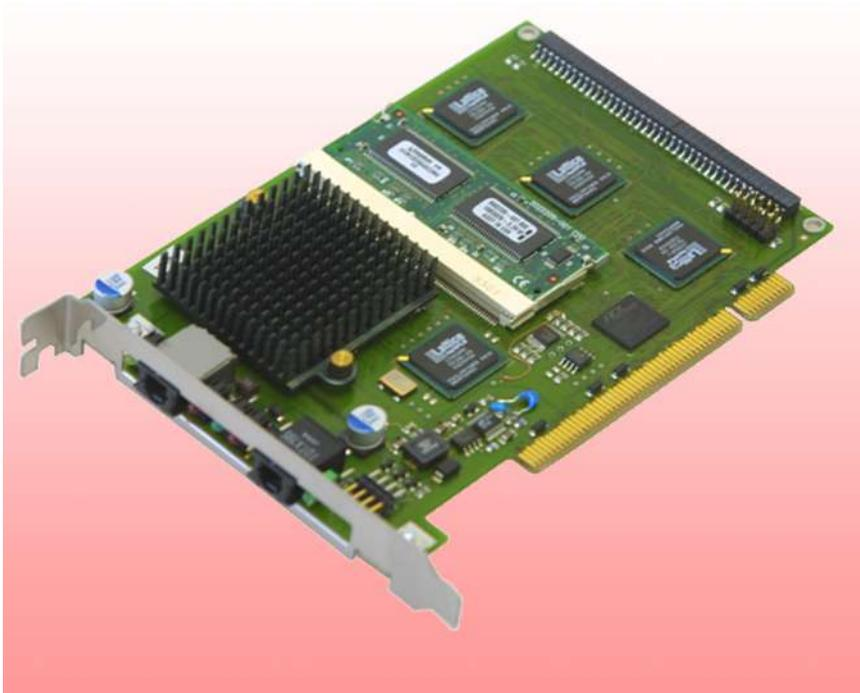
Die INFO-PowerPC Karte ist der Feldbusmaster über einen INFO-Link. Sie liegt als PCI-Bus Steckkarte vor und kann in jedem beliebigen PC oder Industrie PC (IPC) mit dem INCO-Server betrieben werden. Das Herz des Masters ist die leistungsfähige RISC-CPU: PowerPC 750FX, mit bis zu 1 GHz Taktrate. Das Echtzeit Multitasking Betriebssystem des Masters übernimmt die gesamte Steuerung der Maschine/Anlage. D.h. der Master ar-
