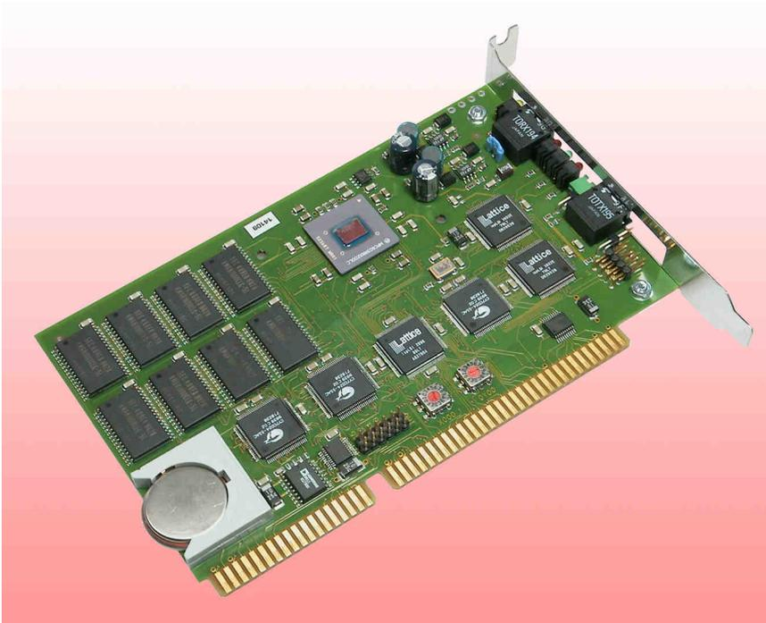
Die INFO-PowerPC Karte ist der Feldbusmaster über einen INFO-Link. Sie liegt als PCI-Bus oder ISA-Bus Steckkarte vor und kann in jedem beliebigen PC oder Industrie PC (IPC) mit dem INCO-Server betrieben werden. Das Herz des Masters ist die leistungsfähige RISC-CPU: PowerPC 603E, mit 200 MHz Taktrate. Das Echtzeit Multitasking Betriebssystem des Masters übernimmt die gesamte Steuerung der Maschine/Anlage. D.h. der Master ar-
