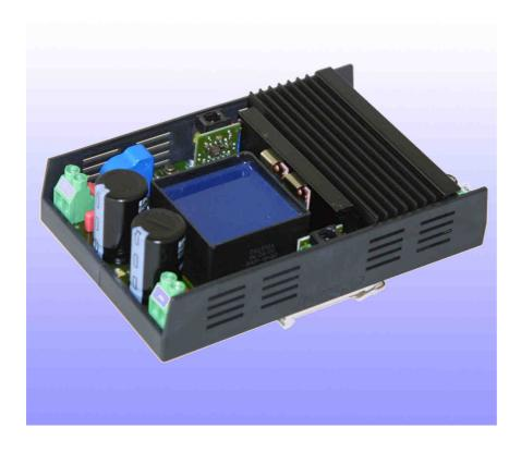
Die INFO-PVC Karte ist eine frei programmierbare Spannungsquelle für den High-Speed Feldbus INFO-Link. Der Spannungsbereich beträgt 0 ... 50 V, der Strombereich ist einstellbar zwischen 0 ... 15 A.
