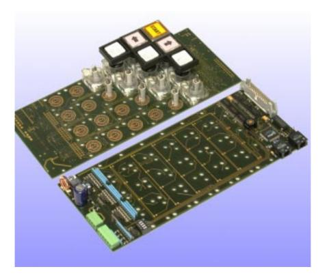
Die INFO-TSP Karte beinhaltet ein Tastenfeld, kombiniert mit einer parallelen Schnittstelle für die Ansteuerung eines LCD-Displays.
