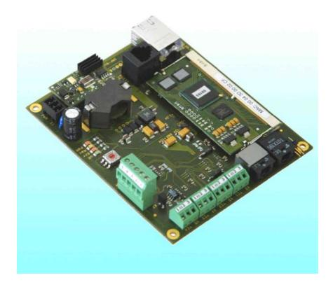
Der IT-MAS2 ist ein universelles Messboard für Thermospannungen und Wägezellen.
