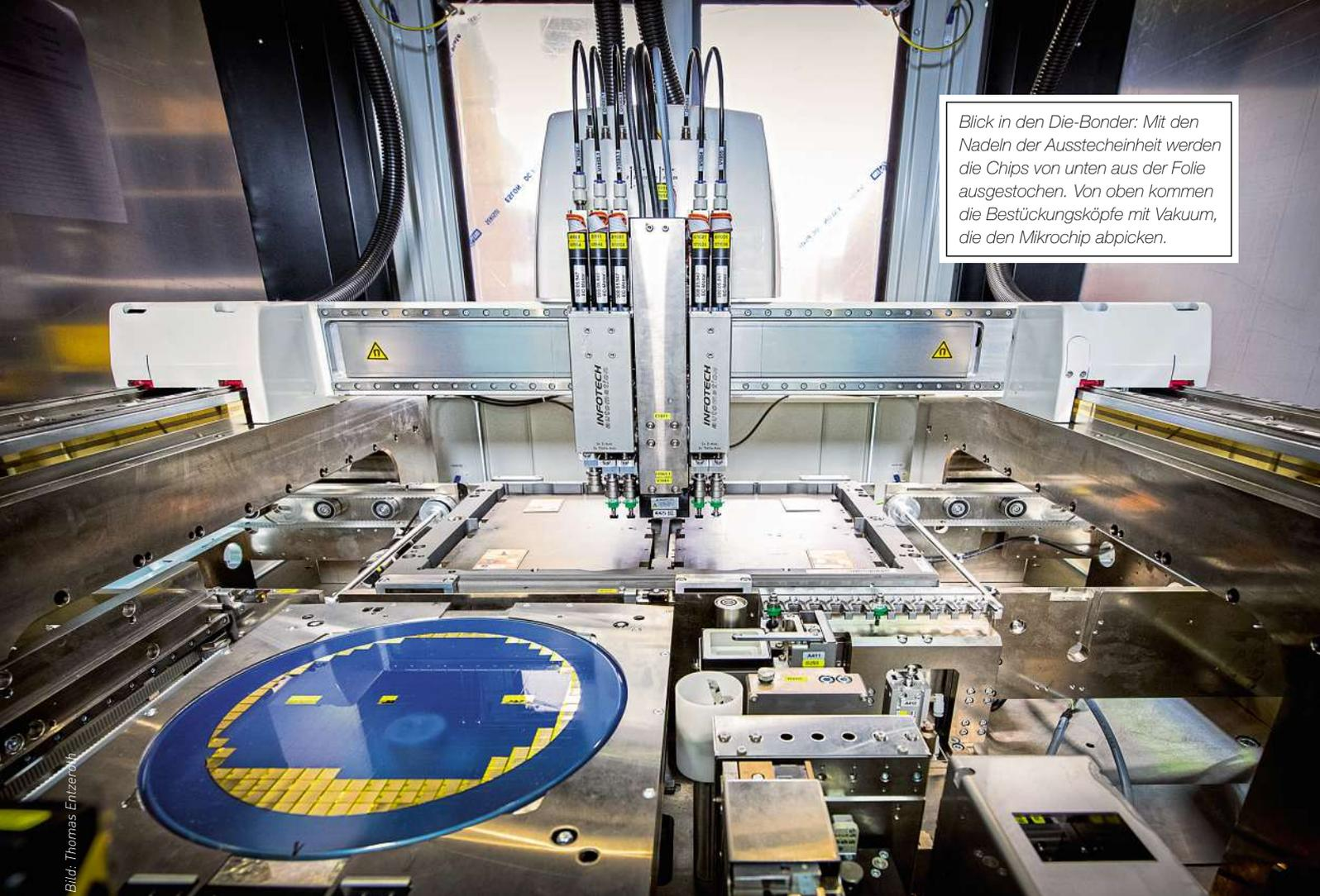
Blick in den Die-Bonder: Mit den Nadeln der Ausstecheinheit werden die Chips von unten aus der Folie ausgestochen. Von oben kommen die Bestückungsköpfe mit Vakuum, die den Mikrochip abpicken.
