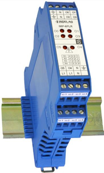
Die digitalen IMP-Ausgänge steuern ohmsche und induktive Lasten mit 230V an. Über die LEDs wird der Schaltzustand der Relais angezeigt. Alle 6 Ausgänge werden gemeinsam über die Pin L1, N versorgt. Die Aktoren können in bequemer 3 Leiter-Technik angeschlossen werden.
