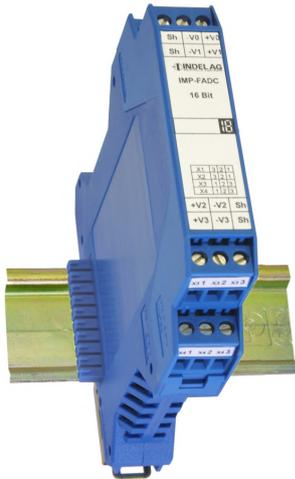
Die Fast AD-Wandler-Karte ist ein multifunktionales analoges Eingangs-Modul. Das Modul kann für die Erfassung von dynamischen Vorgängen oder für langsame und hochpräzise Datenerfassung konfiguriert werden. Auf dem Modul befindet sich pro Kanal ein Shunt der für Strommessungen zugeschaltet werden kann. Die Variante mit dem 12-Bit Wandler liefert schnelle und präzise Messwerte zu einem kostengünstigen Preis. Für hochpräzise Applikationen steht die Karte mit 16-Bit Auflösung zur Verfügung.
