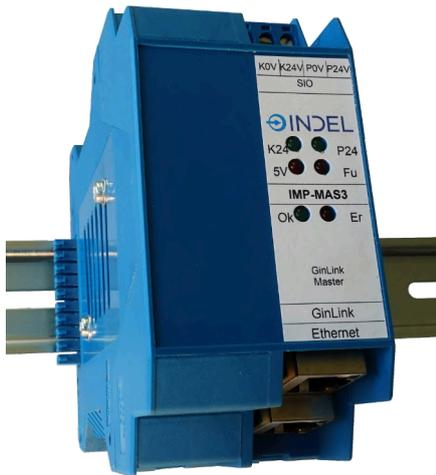
Der IMP-MAS3 ist ein IMP-Master mit leistungsstarker ARM-CPU für Applikationen von einfacher bis mittlerer Komplexität. Als Feldbus-Controller für den GinLink steuert und koordiniert der IMP-MAS3 die gesamte Peripherie. Über den lokalen IMP-Bus können zusätzlich bis zu 16 IMP-Teilnehmer direkt angesprochen werden. Die Spannungsversorgung für weitere Teilnehmer ist diesem Modul bereits integriert.
