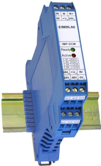
Das Modul IMP-DCM ist ein multifunktionales analoges Ausgangs-Modul. Es beinhaltet einen PWM-Generator und eine MOS-FET Leistungsstufe. Für Positions-Regelungen wird das IMP-DCM Modul zusammen mit dem IMP-INC Modul (Inkrementalgeber Erfassung) eingesetzt. Das Modul kann auch als Sollwert-Geber eingesetzt werden (ungeregelt). Das IMP-DCM wird über die universelle Software-Schnittstelle angesprochen wie die Indel Servo-Regler oder Schrittmotoren.
