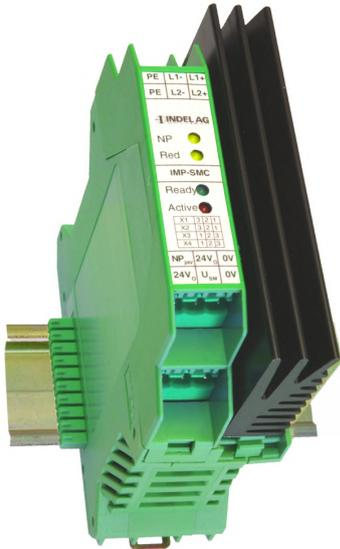
Mit dem IMP-SMC wird ein 2-Phasiger Schrittmotor angesteuert. Das Modul beinhaltet den Indexer zur Erzeugung der Schrittfrequenz und die Endstufe bis 4A Peak. Die ausgegebenen Impulse werden gezählt und in die Positions-Regelung rückgeführt. Zusätzlich kann ein IMP-INC Modul für inkrementale Wegmessung verwendet werden. Das IMP-SMC wird mit der gleichen Software-Schnittstelle angesprochen wie die Indel Servo-Regler oder INFO-4KP.
