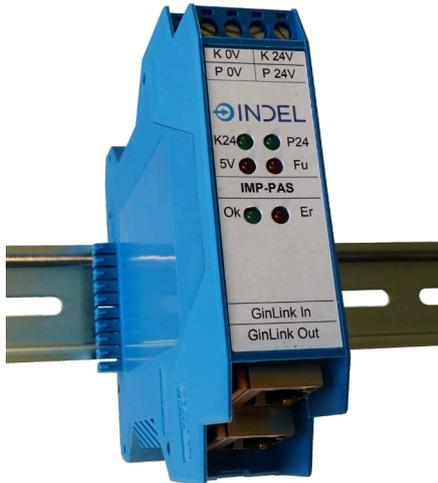
Der IMP-PAS ist ein GinLink nach IMP-Bus Koppler. Über den lokalen IMP-Bus können bis zu 16 IMP-Teilnehmer via GinLink angesprochen werden. Dank den zahlreich vorhandenen Modulen, wie beispielsweise I/O-, Zähler- und Spezial-Module kann das IMP-System ideal an die jeweilige Applikation angepasst und bei Bedarf durch zusätzliche Module erweitert werden. Die Spannungsversorgung für weitere Teilnehmer ist diesem Modul bereits integriert.
