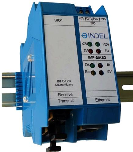
Der IMP-MAS3 ist ein IMP-Master mit leistungsstarker ARM-CPU für Applikationen von einfacher bis mittlerer Komplexität. Als Feldbus-Controller für den INFO-Link steuert und koordiniert der IMP-MAS3 die gesamte Peripherie. Über den lokalen IMP-Bus können zusätzlich bis zu 16 IMP-Teilnehmer direkt angesprochen werden. Die Spannungsversorgung für weitere Teilnehmer ist diesem Modul bereits integriert.
