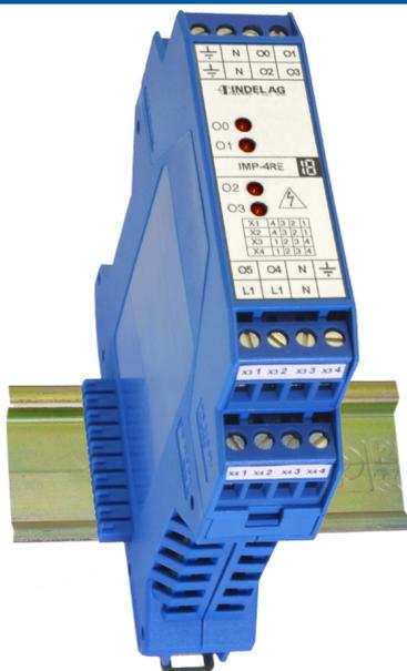
Mit diesem Modul werden ohmsche und induktive Lasten bis zu 1500VA/ 250ACV direkt geschaltet. Über die LEDs wird der Schaltzustand der Relais angezeigt. Die 4 Umschaltkontakte sind untereinander galvanisch getrennt.
