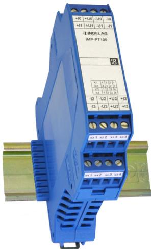
Das IMP-PT100 Modul ist das Messglied für präzise Erfassung von Temperaturen. Die 4 PT-100 Messfühler werden über 4-Draht-Leitungen direkt an das Modul angeschlossen. Um Fehler durch Eigenerwärmung zu vermeiden, fließt der Messstrom nur während der Messung. Zwei präzise Referenz-Widerstände, deren Eigenschaften im EEPROM gespeichert werden, sind für den automatischen Nullpunkt- und Fullscale- Abgleich auf dem Modul eingebaut.
