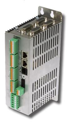
Das GIN-AX4x4 Motion-Board bietet eine kompakte Lösung zur Ansteuerung von bis zu vier Achsen. Dabei werden alle konventionellen Motor- und Gebersysteme unterstützt. Bei Bedarf können zwei Endstufen parallel geschalten werden um die Ausgangsleistung zu verdoppeln.
