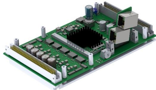
Zusätzlich zu den Motoren können, je nach Anschlussboard, eine Vielzahl an analogen und digitalen Peripherien angeschlossen werden. Weiter stehen sechs PWM-Ausgänge zur Verfügung, welche für beliebige ohmsche und induktive Lasten wie z.B. die Beleuchtung von Kamera-Systemen benutzt werden können.
