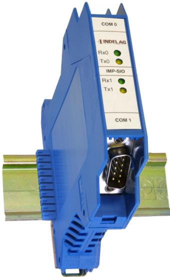
Über die serielle Schnittstelle können Drucker, Bedienpanel und andere Fremdgeräte angeschlossen werden. Datenaustausch zu einer SPS oder anderen intelligenten Systemteilen kann ebenfalls über die SIO vorgenommen werden. Die SIO kann kanalweise (2 Kanäle) für RS-232 oder RS-485 konfiguriert werden.
