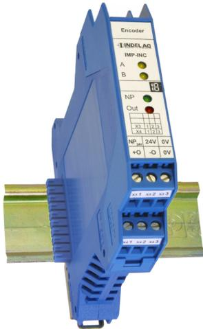
Das Inkremental-Geber Modul enthält einen Inkrementalgeber-Zähler. Zusätzlich ist ein Ausgang und ein Eingang auf dem Modul vorhanden. Der Ausgang wird für die Aktivierung des Reglers, Servoverstärkers benötigt. Der Eingang funktioniert als zusätzlicher Nullimpuls z.B. von einem Nocken.
