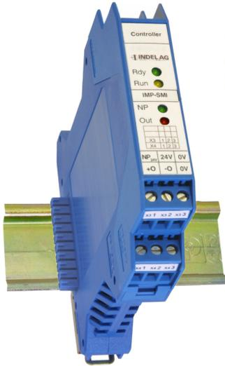
Das IMP-SMI bedient einen Schrittmotor, es beinhaltet die Erzeugung der Schritt-Frequenz sowie ein Signal zur Bestimmung der Drehrichtung. Sämtliche ausgegebenen Impulse werden gezählt und in die Positions-Regelung rückgeführt. Zusätzlich kann ein IMP-INC Modul für inkrementale Wegmessung verwendet werden. Softwaremässig wird das IMP-SMI wie die Servo-Regler oder die Posi-Karte angesprochen; Trapez-Regler mit S-Anteil können verwendet werden.
