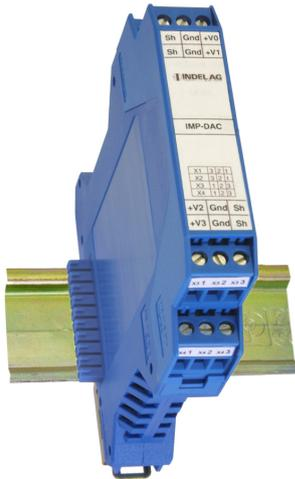
Das Modul IMP-DAC ist ein multifunktionales analoges Ausgangs-Modul. Das Modul kann kanalweise für Strom- oder Spannungs-Ausgabe konfiguriert werden. Dank der Auflösung von 16-Bit lässt sich das IMP-DAC Modul auch zum Regeln von Servo-Achsen verwenden. Die Korrektur für Offset und Gain Fehler sind für jeden Kanal einzeln in einem EEPROM auf der Karte abgelegt. Damit sind sehr präzise Werte vorhanden auch bei hohen Umgebungs-Temperatur-schwankungen.
